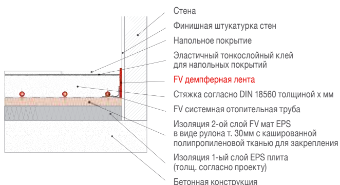
Рисунок 10: Укладка демпферной ленты FV
